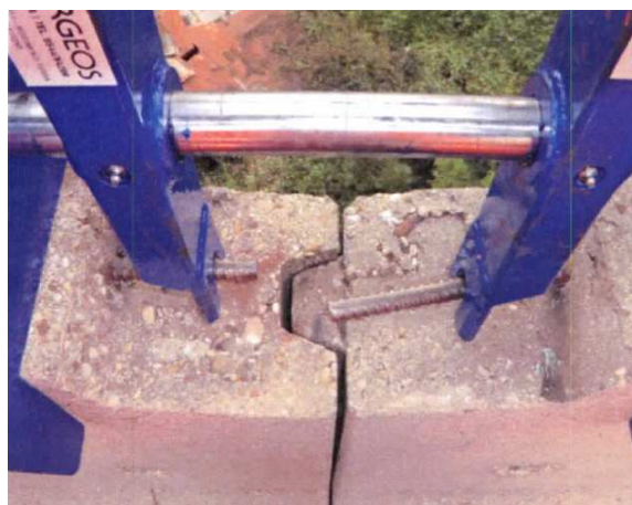
Fig. 7: Disallineamento delle barre dywidag mediante il disassatore dywidag.
